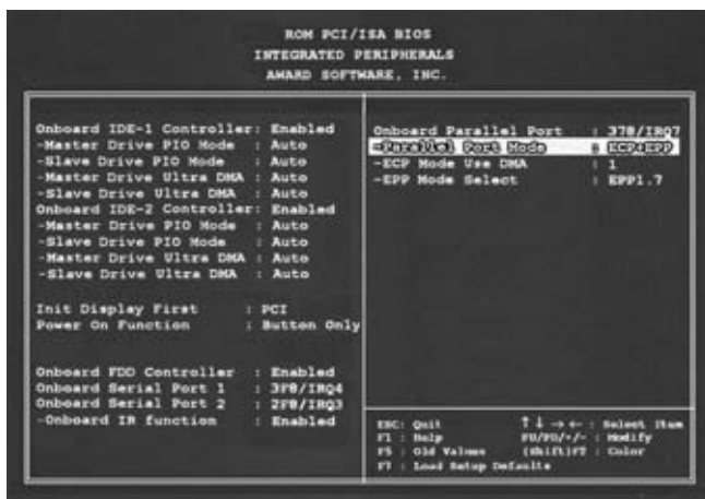
Fig.5 Aspecto del menú INTEGRATED PERIPHERALS en el Setup de las BIOS AMI y AWARD. La opción correspondiente al ajuste del modo del puerto (PARALLEL PORT MODE) está resaltada.
