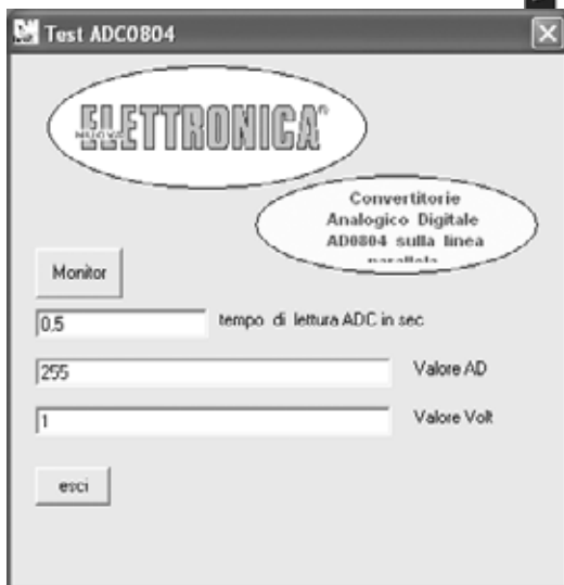
Fig.30 En la ventana principal se puede modificar el tiempo de lectura de la conversión A/D y ver el valor de la conversión (decimal).
