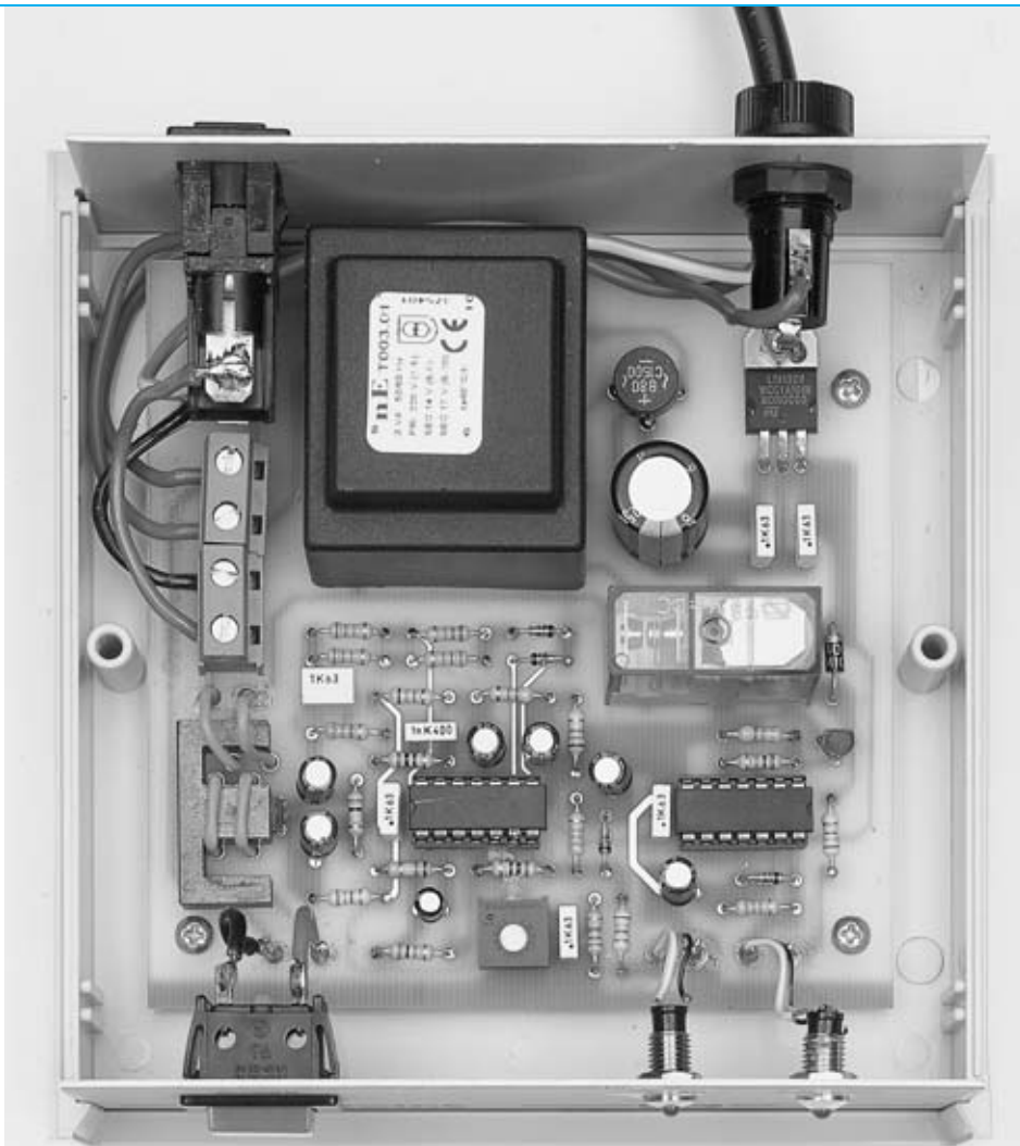
Fig.7 una vez instalado el circuito impreso dentro del mueble plástico hay que realizar las conexiones con los componentes exteriores.
