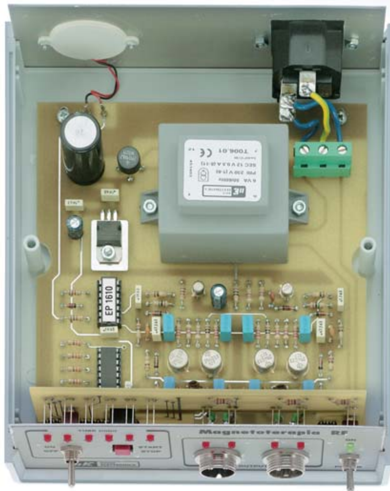
Fig.8 El circuito impreso LX.1610 se fija en la base del mueble utilizando 4 tornillos. En el panel posterior se monta la cápsula CP1 y la toma de 230 voltios (ver Fig.9). En el panel se montan los conectores de las Salidas A y B a los que se conectan los paños irradiantes.
