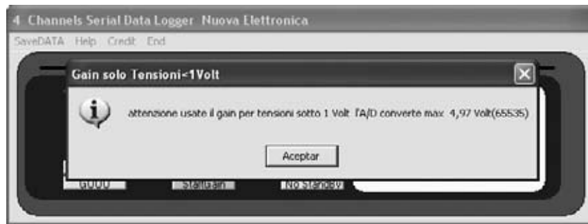
Fig.11 Para activar la función GANANCIA hay que hacer click en el icono GAIN. Al acceder a esta función se muestra un mensaje de aviso indicando que solo hay que utilizar ganancias para tensiones menores de 1 voltio y nunca superar los 4,97 voltios.
