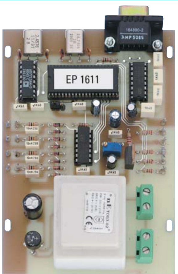
Fig.8 Fotografía del circuito impreso una vez montados todos sus componentes. El Trimmer que se encuentra en la parte central se utiliza para ajustar la tensión de referencia. El impreso de la fotografía carece de serigrafía ya que se trata de un prototipo.
