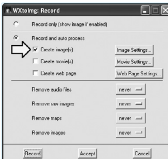
Fig.21 En la ventana RECORD hay que activar RECORD AND AUTO PROCESS y marcar la opción CREATE IMAGE(S). Una vez seleccionadas estas opciones hay que hacer click en ACCEPT.
