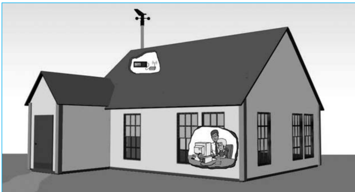
Fig.1 Conectando la Estación meteorológica KM100 a un módulo transmisor y el ordenador personal a un módulo receptor se pueden adquirir directamente los datos meteorológicos de forma inalámbrica (wireless), eliminando de este modo molestas conexiones.
