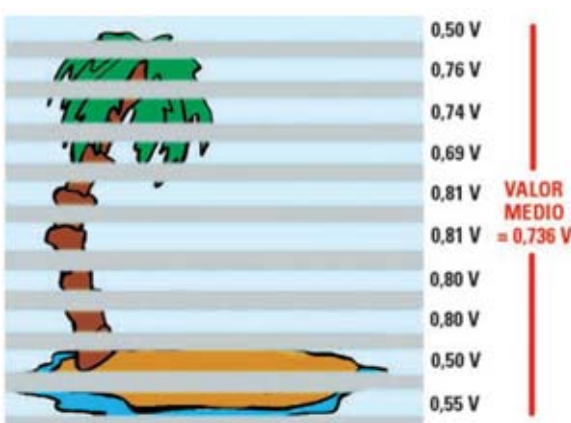
Fig.6 Si la imagen es estática, es decir carente de variaciones, los valores medios de la tensión calculada de cada línea y su valor medio total son constantes.
