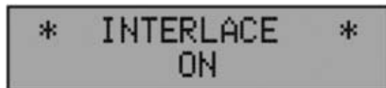
Fig.30 INTERLACE se utiliza para seleccionar modo ENTRELAZADO (ON) o NO ENTRELAZADO (OFF) de líneas en la imagen.
