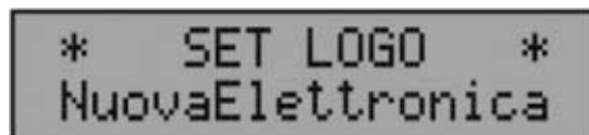
Fig.40 Para escribir la palabra a visualizar hay que utilizar la tecla SEL y los cursores (< >).
