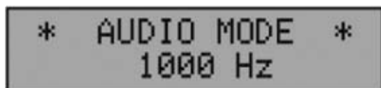
Fig.31 AUDIO MODE ajusta las notas emitidas en la señal BF de audio.
