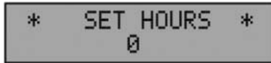
Fig.37 A continuación del año aparece el menú SET HOURS cuya función es ajustar la hora.
