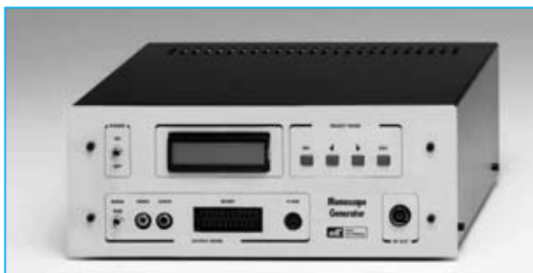
Fig.43 Fotografía del mueble utilizado para el Generador de Monoscopio Profesional. Los pulsadores de instrucción SEL , ESC y CURSORES (< >) se encuentran en la parte superior-derecha. En la parte inferior se encuentran las tomas de salida: Vídeo/Audio (RCA), Scart, S-VHS y RF.
