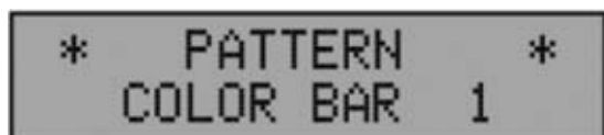
Fig.33 Para ver el Monoscopio y el resto de imágenes patrón hay que utilizar SEL y los cursores (< >).
