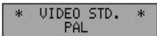
Fig.32 VIDEO STD permite seleccionar el estándar de vídeo entre PAL, SECAM y NTSC.
