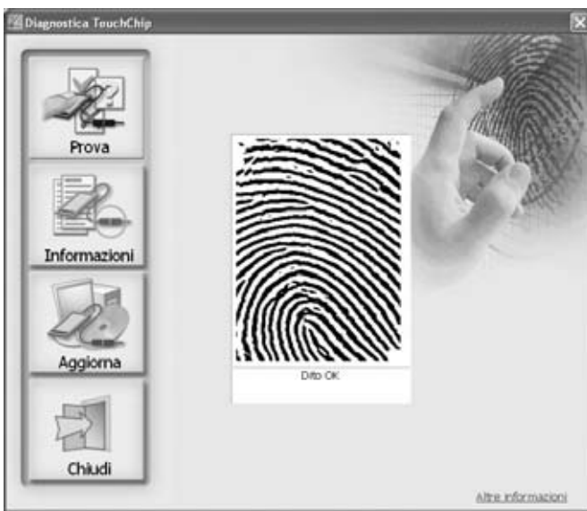
Fig.20 Imagen de la huella capturada por el sensor y convenientemente filtrada por el programa. Para terminar hay que hacer click en CERRAR (Chiudi).
