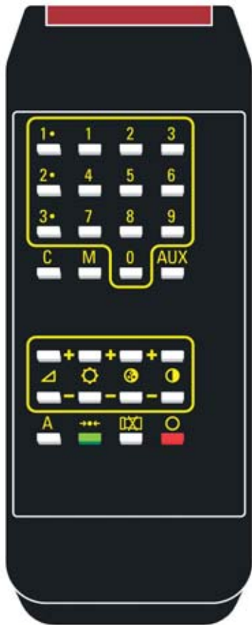
Fig.2 Aspecto del mando a distancia por infrarrojos utilizado para el Light Controller. Este mando a distancia funciona con una pila común de 9 voltios que ha de ser instalada.
