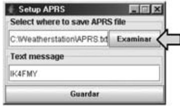
Fig.4 Al Hacer click en SETUP APRS (ver Fig.3) se abre esta ventana. Para guardar los datos de la centralita en el archivo WXPRS.TXT del programa UI-VIEW hay que hacer click en EXAMINAR. Cuando se abra la ventana mostrada a la derecha hay que hacer click en la flecha situada al lado de MIS DOCUMENTOS.
