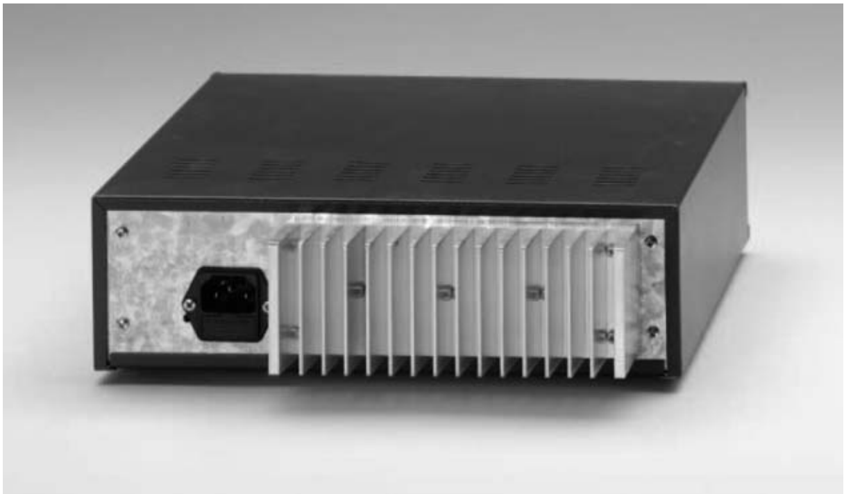
Fig.1 El mueble metálico utilizado para el Alimentador profesional tiene un perfil sencillo y lineal, similar al de la mayoría de dispositivos de laboratorio. Los potenciómetros de control permiten seleccionar el valor de la tensión de salida y ajustar la corriente suministrada. En el panel posterior, mostrado sobre estas líneas, se encuentra la toma de red y la aleta de refrigeración.
