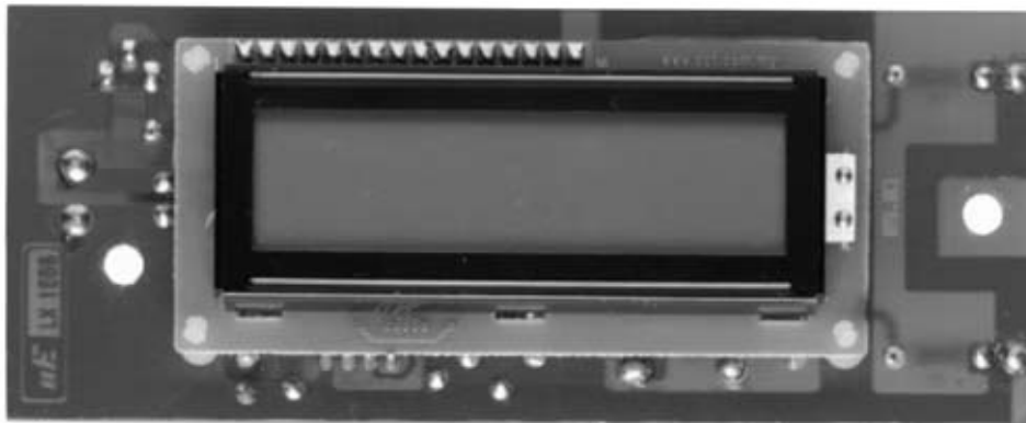
Fig.11 Fotografía del voltímetro-amperímetro visto por el lado del display LCD. Para la realización de esta tarjeta y su ajuste es aconsejable leer con detenimiento el artículo correspondiente en la revista N°231.
