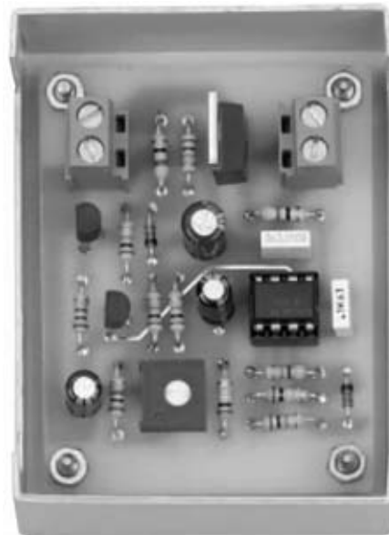
Fig.6 El mueble contenedor estándar MOX30 se proporciona bajo petición expresa. Al tratarse de un mueble estándar carece de los agujeros necesarios para fijar el circuito impreso y para hacer salir los cables de la lámpara y de alimentación.
