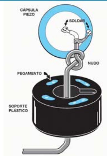
Fig.6 Para montar el disco piezoeléctrico en el soporte de plástico cilíndrico hay que soldar el hilo central del cable apantallado en el centro del disco y la malla metálica en el borde exterior. Una vez realizada la soldadura hay que fijar el disco al soporte utilizando pegamento.
