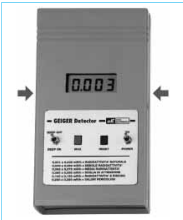
Fig.2 Aspecto del Contador Geiger LX.1407. Las flechas dibujadas a los lados indican la posición de los orificios en los que hace se ha de introducir la punta de un destornillador para poder abrirlo (ver Fig.11).
