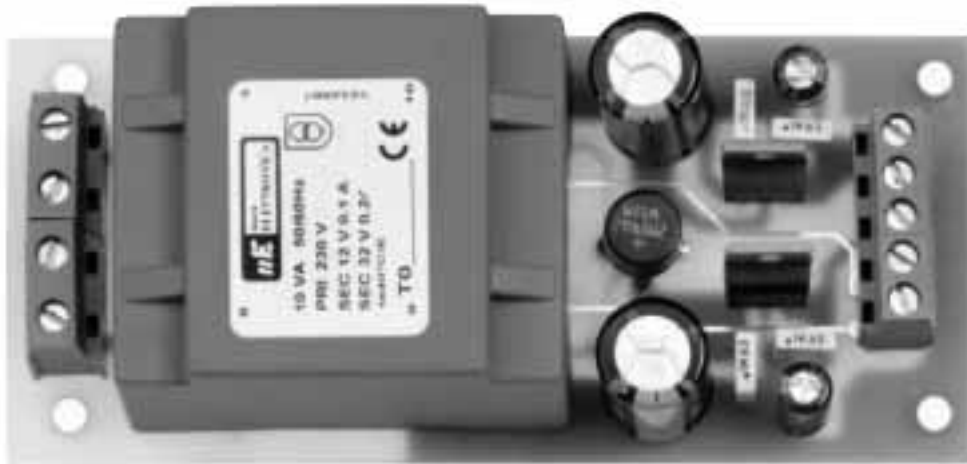
Fig.9 Aspecto del Alimentador LX.1669 con todos sus componentes montados. Este circuito se instala en la base del mueble fijándose con 4 separadores con base autoadhesiva (ver Fig.28).
