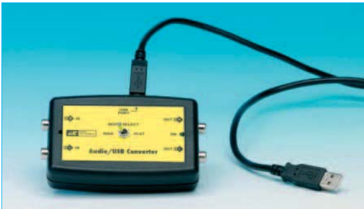
Fig.17 Aspecto del Audio-Convertor USB una vez concluido el montaje. Se puede apreciar claramente el cable de conexión USB que permite su conexión a un ordenador personal posibilitando la grabación y la reproducción de música.
