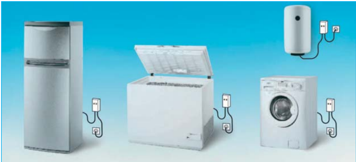
Fig.5 Para que las cargas se alimenten progresivamente después de un apagón hay que ajustar los trimmers R4 de cada circuito LX.1695 con tiempos de retardo diferentes y conectar en serie un LX.1695 a cada electrodoméstico.
