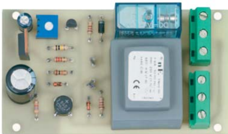
Fig.4 Fotografía del prototipo del circuito LX.1695 una vez montados todos sus componentes. La carga se conecta en la clema superior mientras que el cordón de alimentación se conecta en la clema inferior.
