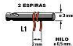
Fig.4 Para construir la bobina L1 hay que envolver 2 espiras de cable de cobre de 0,5 mm de sección sobre un soporte de 3 mm de diámetro. Las espiras se han de espaciar para obtener una longitud total de 2 mm.
