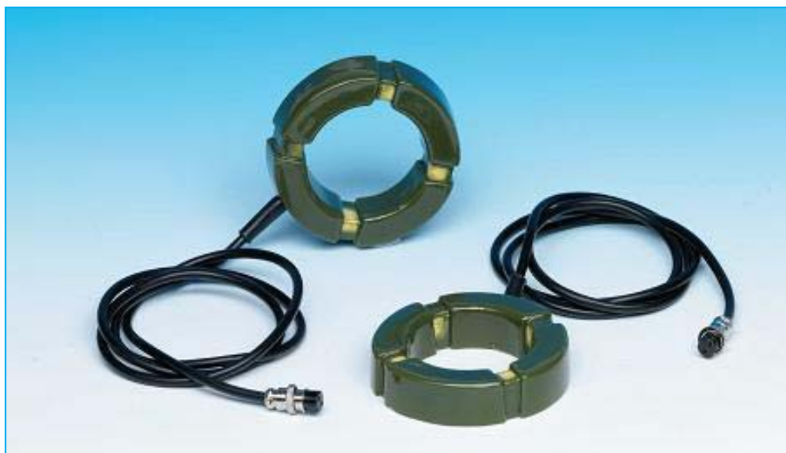
Fig.13 Los difusores circulares MP80 se suministran con cable de conexión y conector DIN para enchufarse directamente a la Magnetoterapia BF LX.1680. Con estos difusores se puede programar una potencia desde 5 hasta 100 gauss con pasos de 1 gauss.
