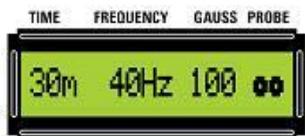
Fig.7 Los círculos bajo PROBE indican que se ha seleccionado la utilización de difusores circulares. Con estos difusores se puede seleccionar una potencia máxima de 100 gauss.
