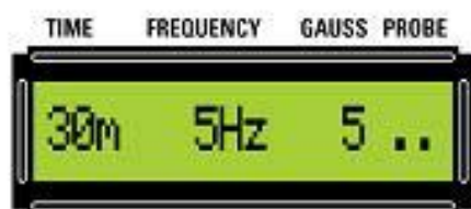
Fig.4 Si bajo la referencia PROBE durante el funcionamiento de la Magnetoterapia aparecen puntos es síntoma de que no hay conectados difusores o bien no funcionan.
