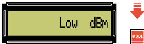
Fig.40 Para modificar la potencia de la señal de salida hay que presionar el pulsador MODE hasta que aparezca una de estas indicaciones: Low / MidL / MidH / High dBm.
