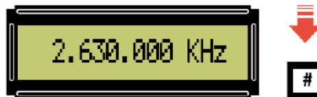
Fig.31 Siempre que se programe un valor de frecuencia hay que presionar la tecla # para que la señal con la frecuencia indicada esté presente en la salida del generador.
