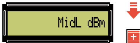
Fig.41 Para visualizar todos los niveles de potencia hay que usar los pulsadores + -. Cuando aparezca el nivel deseado se selecciona con la tecla #. Para salir hay que pulsar en MODE.
