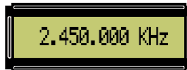
Fig.28 Para obtener en la salida del Generador UHF una frecuencia de 2.450.000 KHz (2,45 GHz) hay que teclear el número 2450000. En el display aparecerá el valor en KHz.
