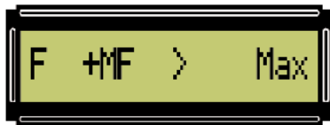
Fig.39 Si en el display aparece la indicación "F+ MF >Max" significa que se ha superado la frecuencia máxima que el generador es capaz de proporcionar.
