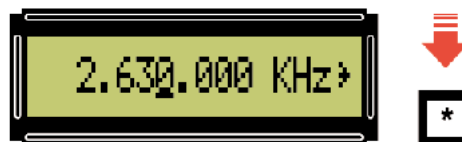
Fig.35 Cada vez que se acciona la tecla * se selecciona la cifra situada a la izquierda de la actual. Después de la cuarta cifra se empieza nuevamente con la primera.
