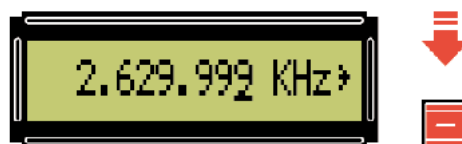
Fig.34 Si, estando seleccionado (subrayado) el 0 situado a la derecha, se presiona el pulsador - se decrementa la frecuencia. En el display aparece 2.629.999 KHz.
