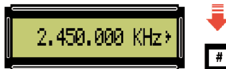
Fig.29 Al presionar la tecla # aparece en la parte derecha del display el símbolo > como confirmación de que en la salida del generador está presente la señal con la frecuencia indicada.
