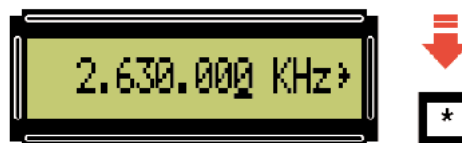
Fig.32 Para variar en pocos KHz la frecuencia que aparece en el display en primer lugar hay que accionar la tecla * hasta que se subraye la cifra a modificar.
