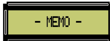
Fig.30 Para almacenar la frecuencia visualizada en el display hay que mantener presionada la tecla # hasta que se vea aparecer una indicación con el texto MEMO.
