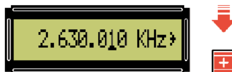
Fig.33 Para obtener una frecuencia de 2.630.010 KHz hay que presionar 2 veces la tecla * de modo que el segundo 0 quede subrayado. Luego hay que utilizar el pulsador +.
