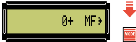
Fig.38 El valor de la MF a sumar o restar de la señal UHF debe expresarse en KHz. Por ejemplo, con una MF de 10,7 MHz (10.700 KHz) hay que escribir el valor 10700.
