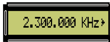
Fig.27 Al encender el Generador UHF aparecerá en el display el valor 2.300.000 KHz. A continuación se puede escribir en el teclado el valor de frecuencia deseado.
