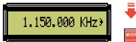
Fig.36 Para cambiar de rango de frecuencias de trabajo hay que apagar y encender (reiniciar) el generador manteniendo presionado el pulsador MODE.
