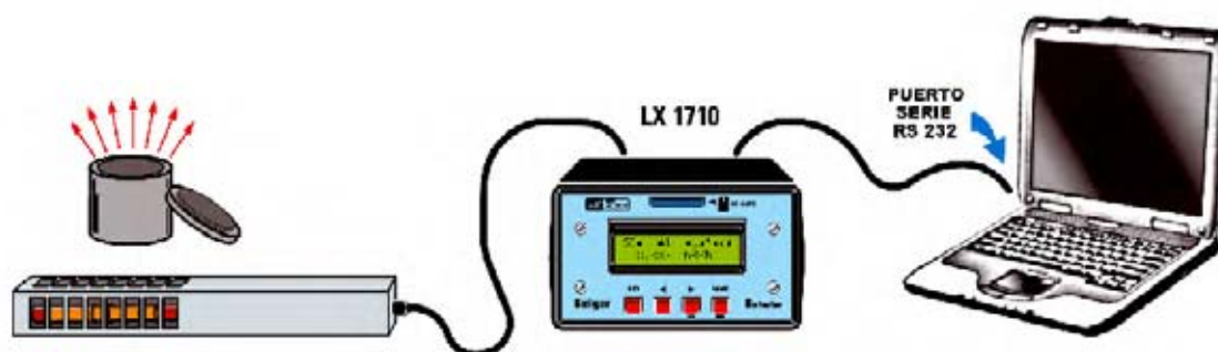
Fig.4 El contador también puede conectarse a un puerto RS232 de un ordenador personal. En este tercer modo operativo los valores de radiactividad medidos por el contador se vuelcan al PC cada 10 segundos, permitiendo observar en tiempo real como varía la intensidad de cualquier fenómeno radiactivo. Los datos capturados pueden almacenarse posteriormente en el disco duro del ordenador.
