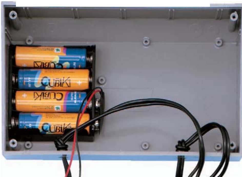
Fig.11 En la parte izquierda del interior del mueble hay que fijar el portapilas utilizando un poco de pegamento rápido. Cuando se instalen las pilas hay que respetar la polaridad de cada una de ellas.
