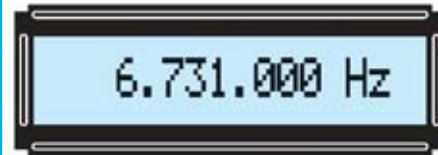
Fig.16 Una inductancia de 18 microH en paralelo con una capacidad de 22 pF, más 9 pF de capacidad parásita, deberían sintonizarse a unos 6.731.000 Hz, por lo que hay que escribir este valor en el teclado del Generador DDS.
