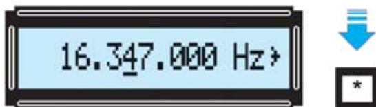
Fig.28 Inicialmente conviene ajustar las decenas de millar de Hz del valor de la frecuencia. Para realizar esta operación hay que seleccionar el quinto dígito empezando por la derecha (leer texto para el procedimiento).
