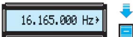
Fig.29. Para ajustar con una mayor precisión la frecuencia de sintonía conviene operar con las unidades de millar de Hz. Una vez seleccionado el cuarto dígito hay que accionar el botón - del panel hasta leer 16.165.000 Hz.
