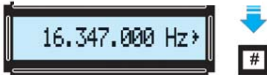
Fig.26 Una vez tecleado el valor requerido hay que presionar la tecla # para obtener la señal en la salida del Generador DDS. En la parte derecha del display LCD se muestra el símbolo > como confirmación.
