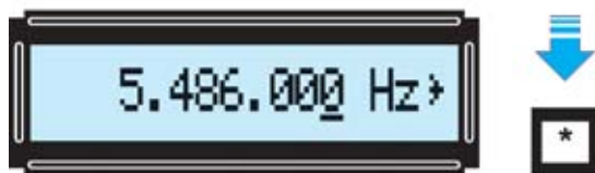
Fig.6 Para variar la frecuencia programada hay que presionar la tecla *. El dígito situado más a la derecha quedará será subrayado indicando que está seleccionado. Utilizando los botones + - del panel se puede modificar su valor.
