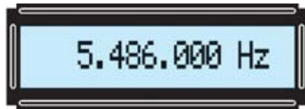
Fig.4 Una inductancia de 15 microH en paralelo con una capacidad de 47 pF, más 9 pF de capacidad parásita, deberían sintonizarse a unos 5.486.000 Hz, por lo que hay que escribir este valor en el teclado del Generador DDS.
