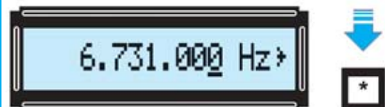
Fig.18 Para variar la frecuencia programada hay que presionar la tecla *. El dígito situado más a la derecha quedará será subrayado indicando que está seleccionado. Utilizando los botones + - del panel se puede modificar su valor.
