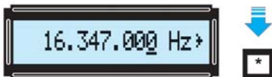
Fig.27 Para variar la frecuencia programada hay que presionar la tecla *. El dígito situado más a la derecha quedará será subrayado indicando que está seleccionado. Utilizando los botones + - del panel se puede modificar su valor.
