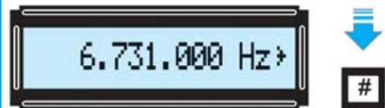
Fig.17 Una vez tecleado el valor requerido hay que presionar la tecla # para obtener la señal en la salida del Generador DDS. En la parte derecha del display LCD se muestra el símbolo > como confirmación.
