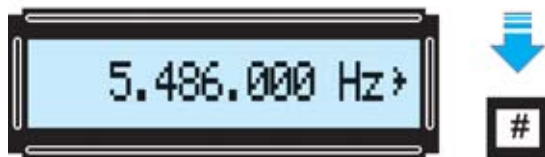
Fig.5 Una vez tecleado el valor requerido hay que presionar la tecla # para obtener la señal en la salida del Generador DDS. En la parte derecha del display LCD se muestra el símbolo > como confirmación.
