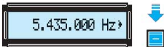
Fig.8 Para ajustar con una mayor precisión la frecuencia de sintonía conviene operar con las unidades de millar de Hz. Una vez seleccionado el cuarto dígito hay que accionar el botón - del panel hasta leer 5.435.000 Hz.
