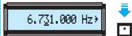
Fig.19 Inicialmente conviene ajustar las decenas de millar de Hz del valor de la frecuencia. Para realizar esta operación hay que seleccionar el quinto dígito empezando por la derecha (leer texto para el procedimiento).
