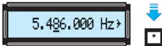
Fig.7 Inicialmente conviene ajustar las decenas de millar de Hz del valor de la frecuencia. Para realizar esta operación hay que seleccionar el quinto dígito empezando por la derecha (leer texto para el procedimiento).
