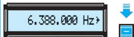
Fig.19 Inicialmente conviene ajustar las decenas de millar de Hz del valor de la frecuencia. Para realizar esta operación hay que seleccionar el quinto dígito empezando por la derecha (leer texto para el procedimiento).
