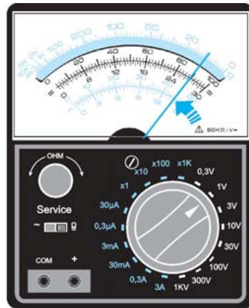
Fig.10 Para determinar el valor de las frecuencias mínima y máxima (F1-F2) a -3 dB hay que utilizar los botones + - del panel del Generador DDS hasta que el tésfer indique un valor de 0,87 voltios.
