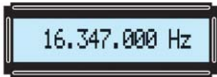
Fig.25 Una inductancia de 2,2 microH en paralelo con una capacidad de 33 pF, más 10 pF de capacidad parásita, deberían sintonizarse a unos 16.347.000 Hz, por lo que hay que escribir este valor en el teclado del Generador DDS.
