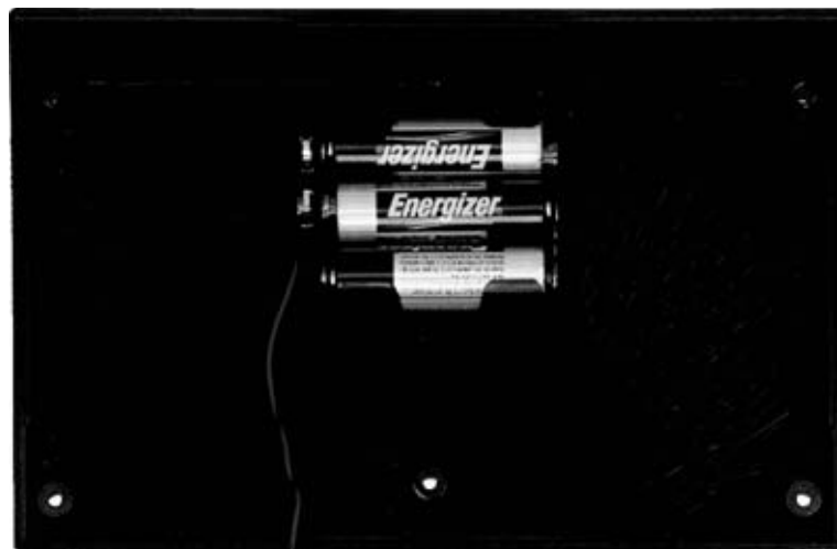
Fig.5 En la base del mueble plástico hay que fijar el portapilas utilizando pegamento rápido. En su interior hay que instalar 3 pilas de 1,5 voltios tipo AAA, teniendo mucho cuidado en respetar la polaridad (+/-).
