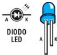
Fig.8 En todos los diodos LED su terminal más largo es el ánodo (A) mientras que el más corto es el cátodo (K). Al instarlos en el circuito impreso hay que respetar la polaridad de los terminales indicada en la serigrafía.
