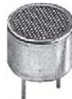
Fig.8 La cápsula receptora RX cuenta con la indicación 400SR. Cualquier otro símbolo no es significativo.
