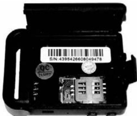
fig.10 abrir el TRACKER tirando hacia afuera la palanca y levantad la tapa para insertad en los espacios previstos la tarjeta Sim-Card y la batería, después cerrad la tapa.
