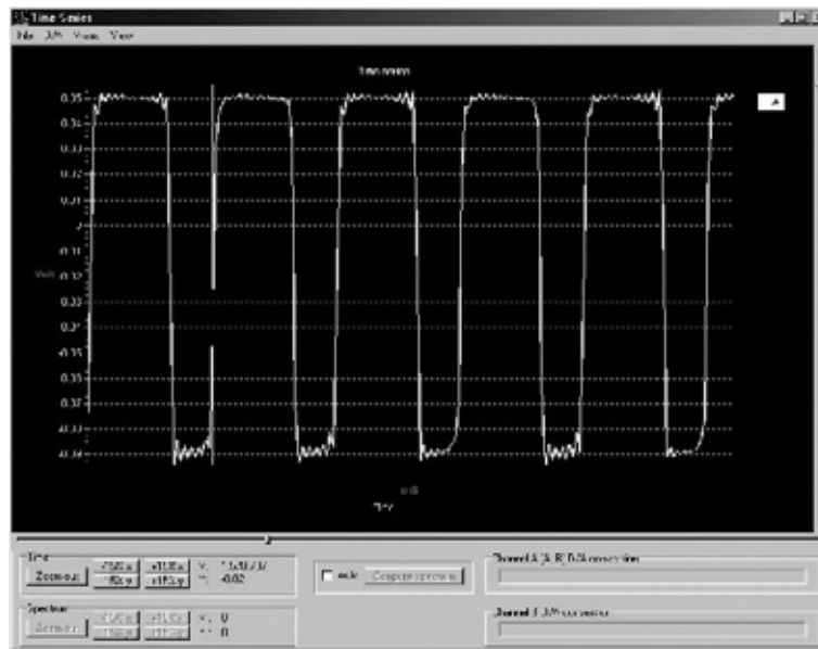
Fig.35 como se puede observar, la señal producida por el oscilador esta constituida por una serie de ondas rectangulares .
