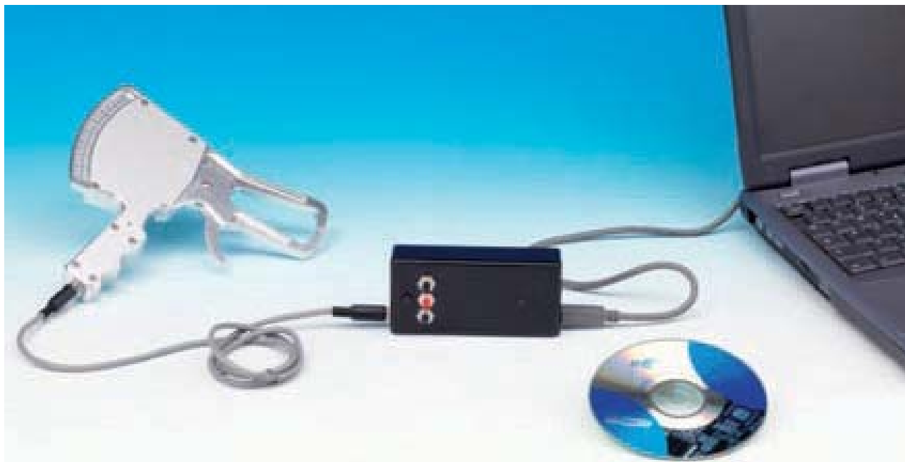
Fig.1 en la fotografía se puede ver la tarjeta USB KM1734K, la pinza para comprobar los pliegues de la piel y el CD-Rom, con el que podréis realizar la medición de la masa gorda siguiendo las indicaciones que os suministramos en el artículo.
