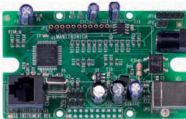
Fig.4 foto de la tarjeta USB KM1734K que os suministramos ya montada y probada con los componentes en SMD.
