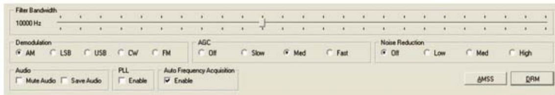
Fig.28 Aquí se ve el menú principal del programa Dream. De izquierda a derecha se pueden ver los 5 submenús Demodulation, AGC, Noise Reduction, Audio, PLL y Auto Frequency Acquisition.
