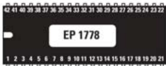
Fig.6 A la izquierda las conexiones de la Eprom EP1778 vista desde lo alto y con la marca de referencia apuntando a la izquierda.
