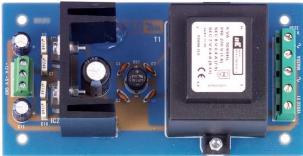
Fig.10 Arriba, la foto del sistema de alimentación una vez terminado el montaje. Abajo, el dibujo del alimentador.
