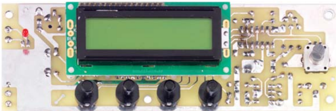
Fig.22 Así se ve el circuito impreso LX.1778 tras haber fijado el display LCD y el resto de componentes que van sobre este lado.
