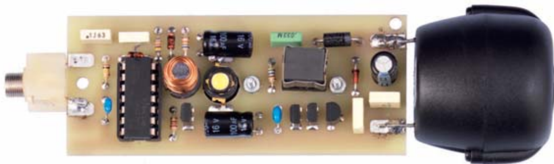
Fig.7 En esta foto se ve el circuito de la sirena una vez terminado el montaje. Este modelo de ejemplo se ha usado en nuestros test.
