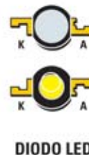
Fig.3 Conexiones del integrado 74HC14 vistas desde arriba y con la marca de referencia hacia la izquierda, de los transistores BC547 y ZTX653 vistos desde abajo, y vista frontal y trasera de las conexiones del diodo led de 1 Vatio por SMD (código =DL4.1).
