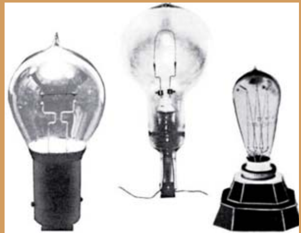
Fig.4 De izquierda a derecha: la lámpara incandescente desarrollada en 1878 por Swan, la lámpara con filamento de carbono desarrollada en 1879 por Edison y la lámpara con filamento de osmio construida por Auer en 1902.
