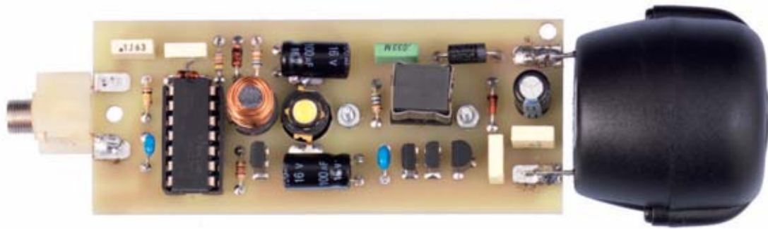
Fig.9 Así se presenta el circuito de la sirena una vez introducido en el tubo de plástico transparente utilizado como contenedor para permitir la vista de la luz flash emitida por el diodo led.
