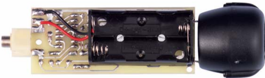
Fig.8 Foto del montaje visto desde el lado en que se fija el portapilas.
