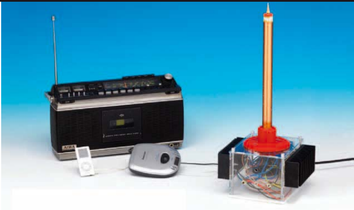
Fig.1 En esta foto se puede ver cómo queda el proyecto del estroboscopio con led de potencia una vez terminado el montaje.
