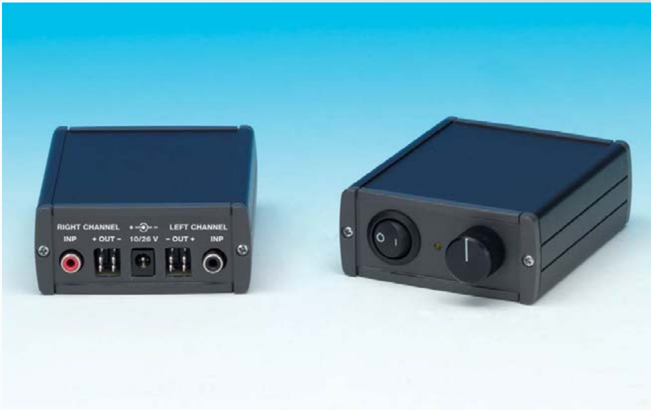
Fig. 1 Así es el amplificador LX.1794 de clase D una vez concluido el montaje.
