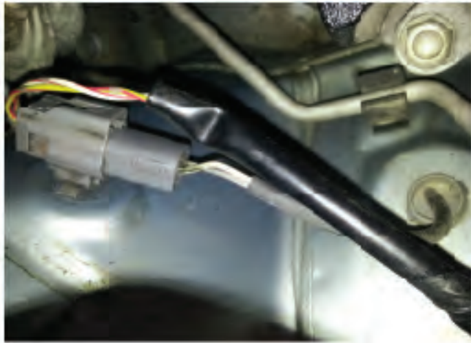
Fig.7 En primer plano el conector provisto de dos cables de entrada y dos de salida.
