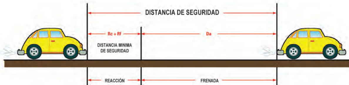
Fig.3 la distancia de seguridad para ser mantenida con el fin de evitar la colisión con un obstáculo u otro vehículo viene dada por la suma del tiempo de reacción del conductor más el espacio de frenado efectivo.
