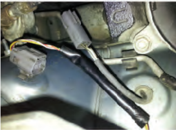
Fig.8 Desconecte el conector y añada en paralelo dos cables para ser conectados al aparato.
