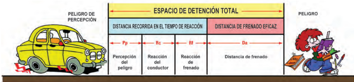
Fig.2 en este dibujo se describe lo que sucede cuando el conductor de un vehículo tiene percepción de un obstáculo sobre su directriz de marcha. Como se puede ver, la distancia total de frenado es la suma del espacio recorrido en el tiempo de reacción y el espacio del de frenado efectivo.
