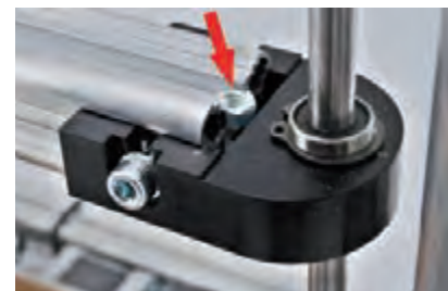
Insertión de la tuerca M5 en la parte superior del brazo.
