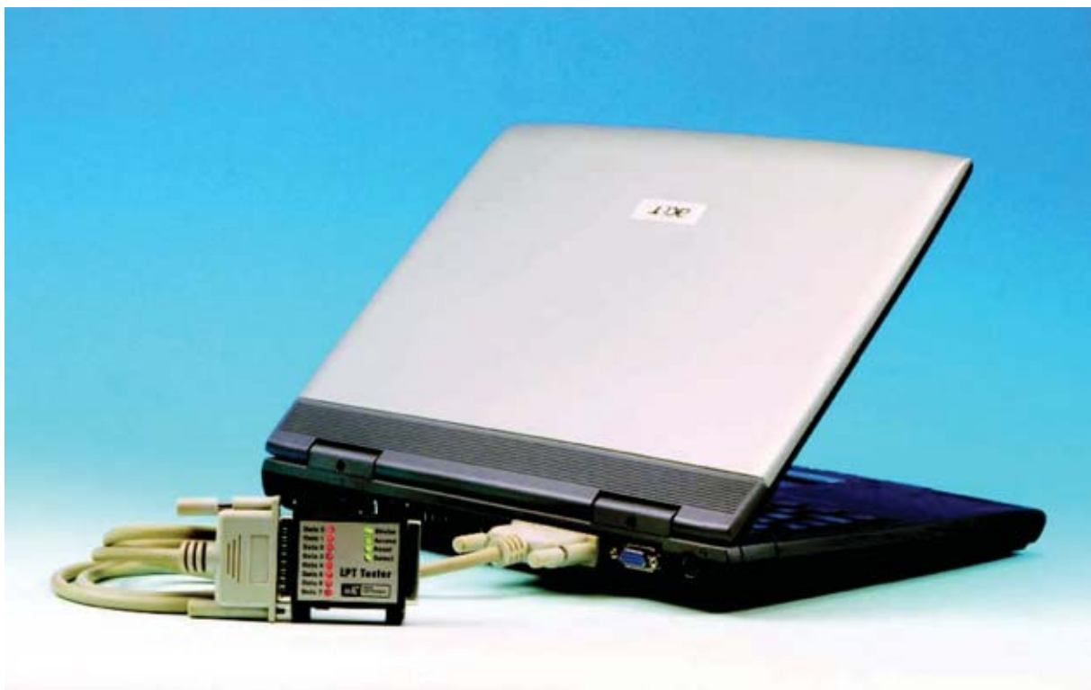
Fig.12 El Téster LX.1588 se conecta al puerto paralelo del ordenador, bien directamente o a través de un cable alargador que incorpore conectores SUB-D 25 macho y hembra en sus extremos.
