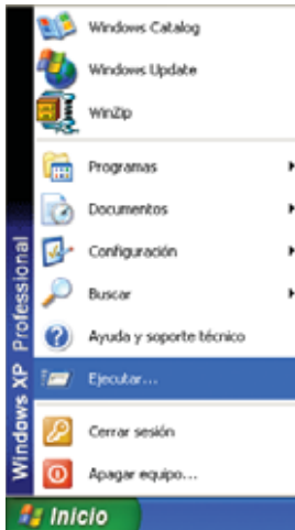
Fig.13 El primer paso para instalar el programa LPT Tester consiste en hacer click en el botón INICIO y, a continuación, hacer click en EJECTAR.
