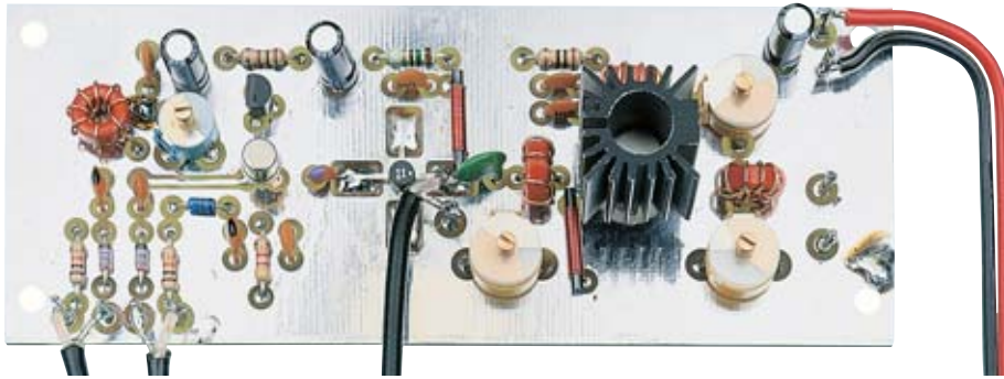
Fig.13 Fotografía del circuito impreso LX.1603 (VCO) con todos sus componentes montados. Para conectar esta etapa a la etapa PLL hay que utilizar cable coaxial RG.174, teniendo presente que se ha de conectar la malla de protección a los terminales de masa de ambos los circuitos impresos. En el kit se incluye 1 metro de cable coaxial RG.174.
