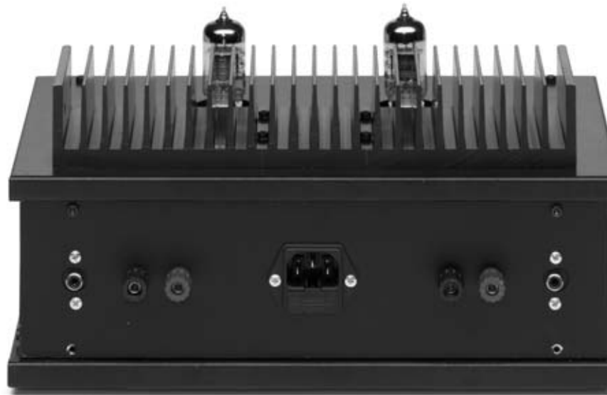
Fig.5 Fotografía del mueble, visto por la parte posterior. Se puede observar la toma de red de 230 voltios, los 4 bornes para las cajas acústicas y los 2 conectores de entrada para la señal estéreo BF.
