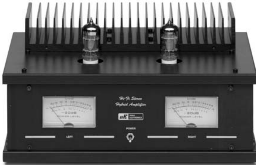
Fig.4 Fotografía del mueble, visto frontalmente. Se pueden apreciar claramente las dos válvulas utilizadas para la etapa de entrada y la aleta de refrigeración utilizada para enfriar los MOSFET finales.
