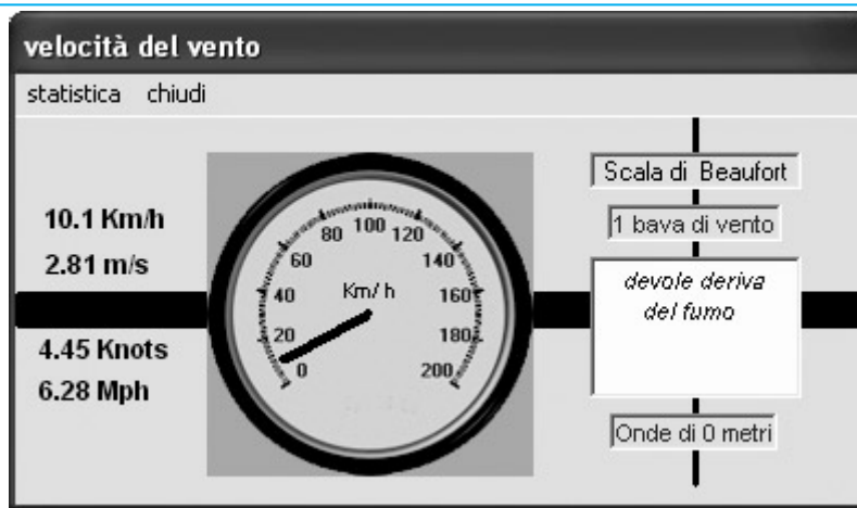
Fig.26 Haciendo click en el botón VELOCIDAD (velocità) de la Fig.20 se muestra el valor de la velocidad del viento en varias unidades de medida: Kilómetros por hora (Km/h), metros por segundo (m/s), millas náuticas por hora (Knots) y millas terrestres por hora (Mph). También se expresa la velocidad del viento según los efectos que provoca en base a la clasificación de Beaufort. Por último, en el apartado inferior-derecho, se proporciona la estimación prevista de la altura de las olas en el mar.
