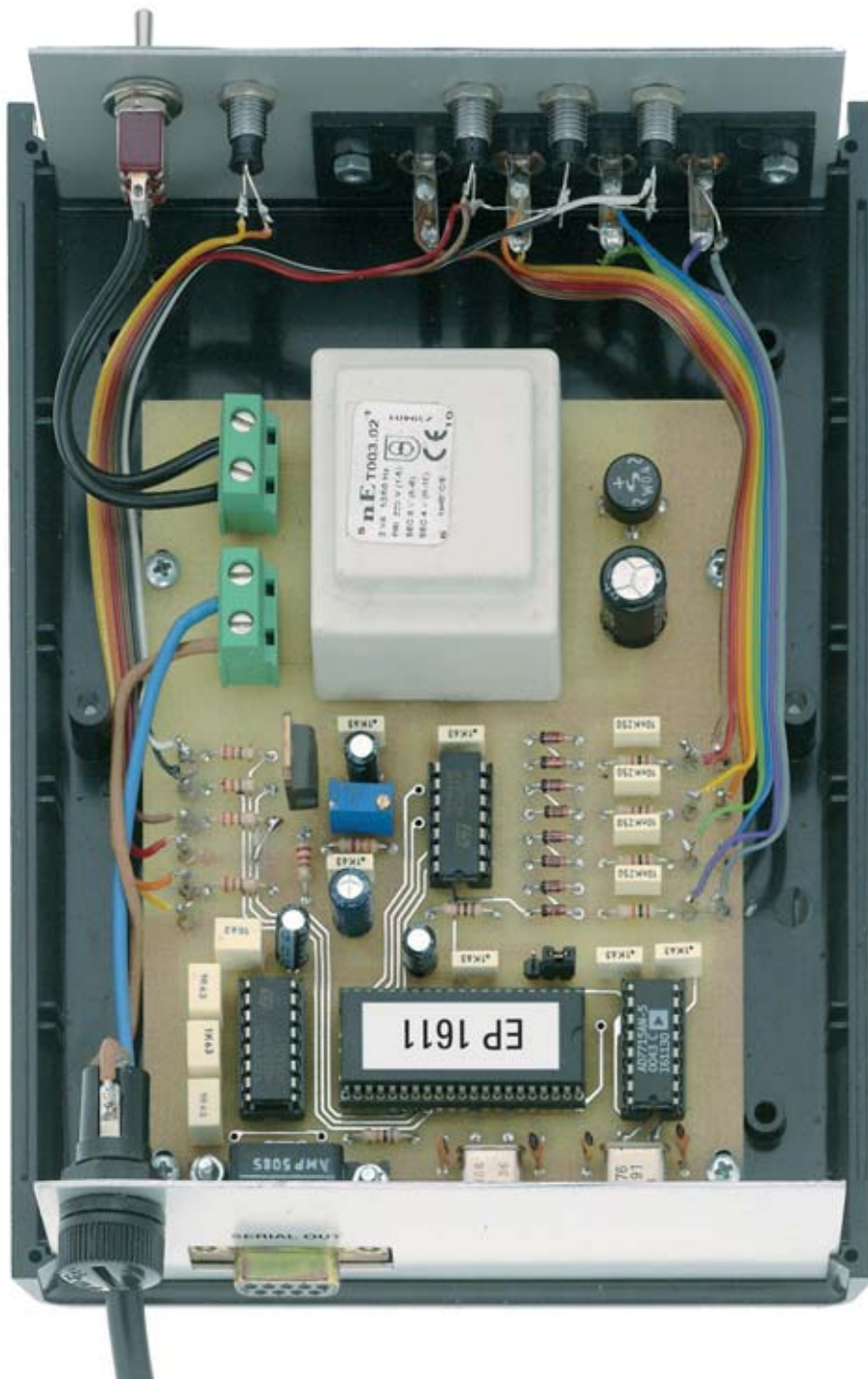
Fig.9 Fotografía de la tarjeta LX.1611 una vez instalada dentro del mueble contenedor. En la parte inferior-izquierda se puede observar el conector hembra de 9 polos utilizado para la comunicación con el ordenador, mientras que en la parte superior se pueden observar las conexiones entre el circuito impreso y los componentes instalados en el panel frontal del mueble.
