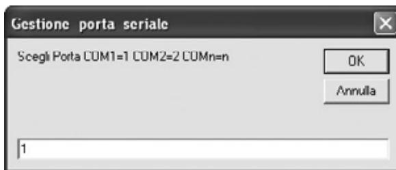
Fig.19 Para activar la comunicación entre ordenador y la centralita de la Estación Meteorológica hay que escribir el número correspondiente al puerto serie que tiene conectado el cable procedente de la centralita KM.100.
