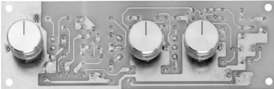
Fig.4 Fotografía del circuito impreso del Preamplificador BF con control de tonos visto por el lado de las pistas. Todas las pistas de cobre del circuito impreso proporcionado están protegidas con barniz antioxidante. La placa de esta fotografía carece de serigrafía y de barniz ya que se trata de un prototipo.
