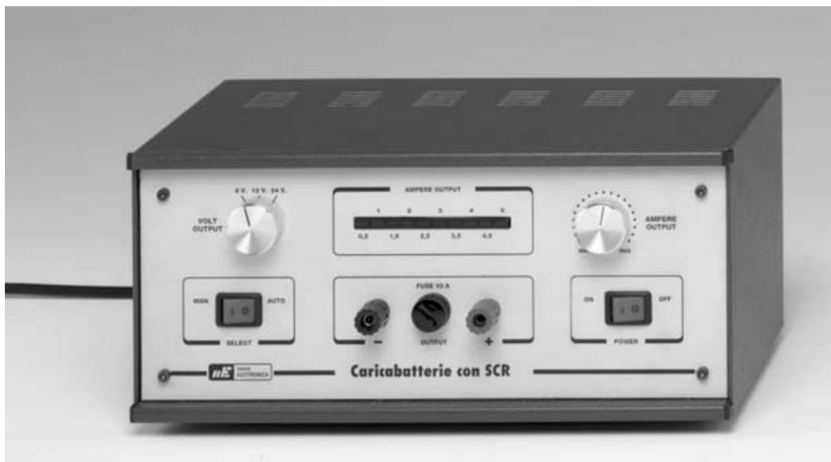
Fig.8 Fotografía del mueble contenedor del cargador de baterías profesional. A la izquierda se encuentra el conmutador selector de la tensión de carga, mientras que a la derecha se encuentra el potenciómetro selector de corriente con la barra de diodos LED indicadora de la corriente de carga real. En el centro se encuentran los bornes para conectar la batería y el fusible de protección. A sus lados se encuentran el interruptor de encendido y el selector de modo Automático o Manual.
