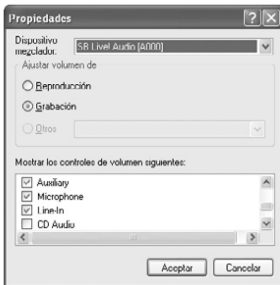
Fig.21 En la ventana de control de la tarjeta de sonido hay que hacer click en OPCIONES y, seguidamente, en PROPIEDADES.
