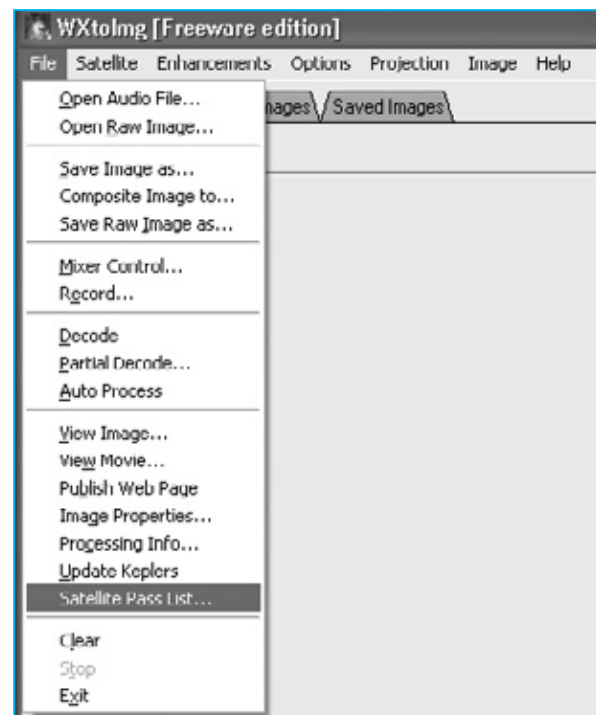
Fig.14 Haciendo click en la opción SATELLITE PASS LIST... del menú FILE se muestra en pantalla una lista actualizada con los pasos de los satélites activados en la ventana mostrada en la Fig.9.
