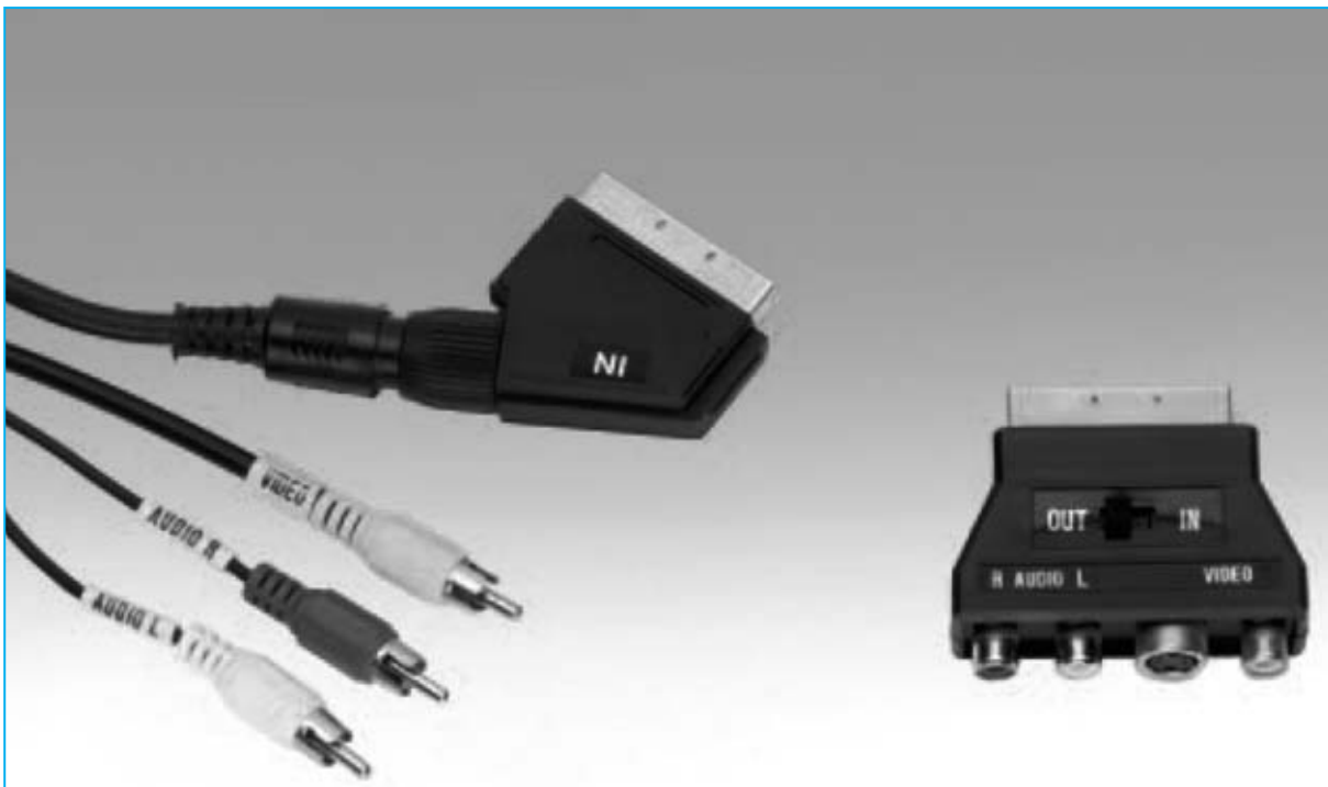
Fig.10 En los comercios se pueden encontrar fácilmente cables de conexión Audio/Vídeo RCA y, en caso de ser necesarios, adaptadores RCA-Scart (euroconector).
