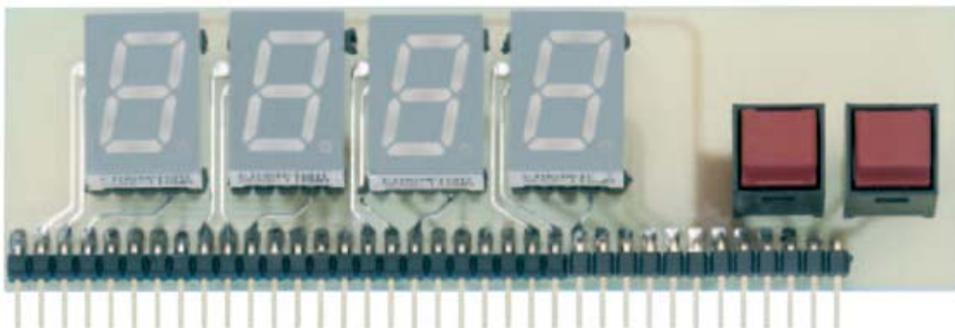
Fig.7 Aspecto de la tarjeta display LX.1634/B una vez montados los dígitos de 7 segmentos, los dos pulsadores y el conector macho de 36 polos.
