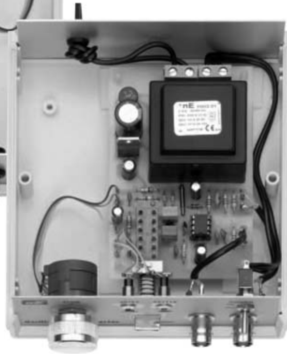
Fig.10 Fotografía del interior del mueble visto por detrás. Se pueden apreciar claramente las conexiones de los componentes instalados en el panel frontal.
