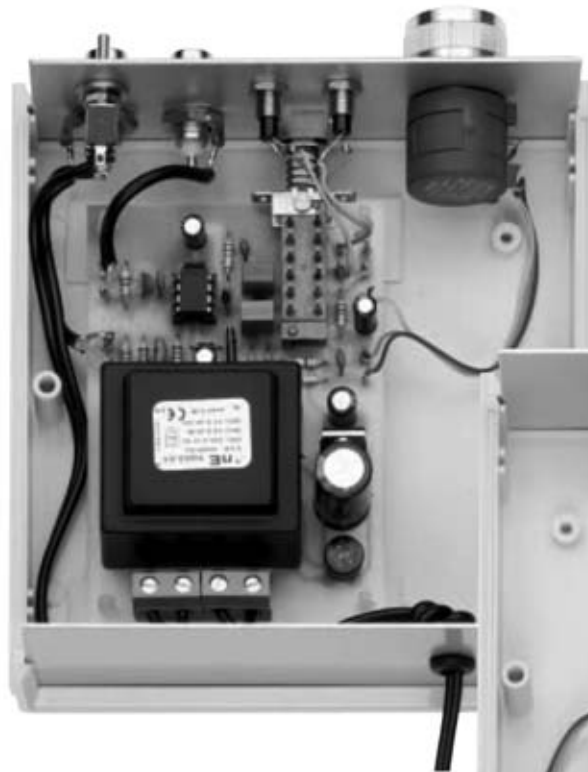
Fig.11 En esta fotografía se muestra el interior del mueble visto por el lado opuesto. Para fijar el circuito impreso en la base del mueble hay que cortar dos separadores.
