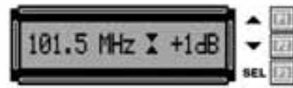
Fig.21 Una vez encendido, el display muestra la frecuencia en MHz, el modo (mono o estéreo) y la ganancia/atenuación.
