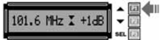
Fig.22 Para aumentar la frecuencia de transmisión únicamente hay que pulsar la tecla superior (P1).
