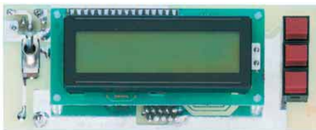
Fig.15 Una vez realizado el montaje mostrado en la Fig.14 se puede instalar el Display. El pulsador P3 sirve para seleccionar las diferentes funciones mientras que P1-P2 se utilizan para variar los valores de la función seleccionada, tal y como se indica en las Figs.19-32.
