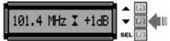
Fig.23 Para disminuir la frecuencia de transmisión únicamente hay que pulsar la tecla central (P2).
