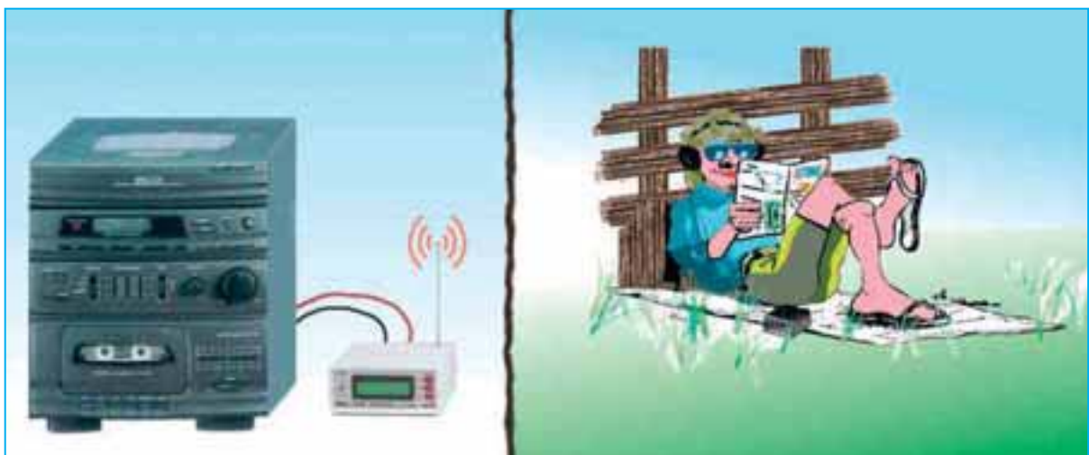
Fig.4 Conectado el excitador FM a vuestra instalación Hi-Fi se puede escuchar la música en el jardín o en cualquier punto de la casa. Si se conecta al excitador FM una cápsula microfónica preamplificada, ajustándolo en Mono, se puede utilizar como radiomicrofono para controlar a distancia a niños pequeños, enfermos y ancianos.
