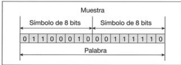
Figura 20. El formato de una palabra de 16 bits está constituido por dos símbolos de ocho bits cada uno.
