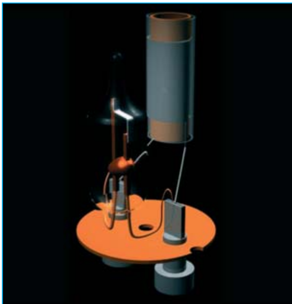
Fig.3 Al alimentar el tubo los contactos del cebador se cierran.
