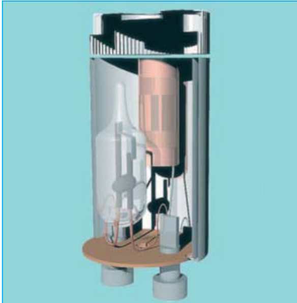
Fig.2 El cebador es el dispositivo que posibilita el encendido de los tubos de neón. En interior de una pequeña ampolla de vidrio hay gas argón, dos contactos de una lámina bimetálica (normalmente abiertos) y un condensador.
