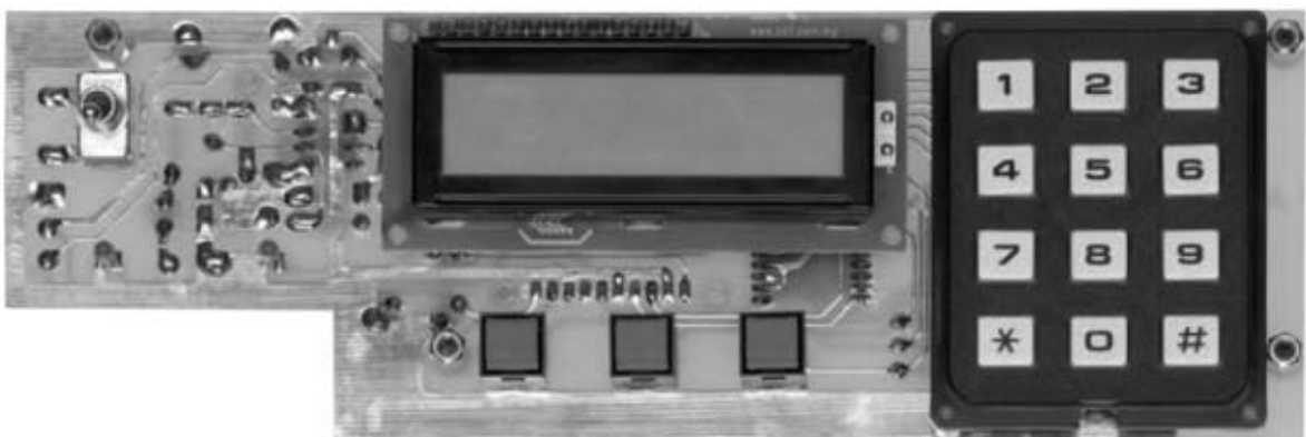
Fig.10 Sobre el mismo circuito impreso mostrado en la Fig.9 se montan los 3 pulsadores P1-P2-P3, el interruptor S1 y los diodos LED DL1-DL2, controlando en estos su altura para que sobresalgan ligeramente del panel frontal y la polaridad de sus terminales (el Ánodo es el terminal más largo). En caso de que los separadores de plástico entren con dificultad en sus agujeros correspondientes se pueden ablandar ligeramente acercando la punta del soldador.
