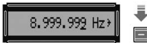
Fig.26 Pulsando la tecla - la frecuencia disminuye 1 Hertzio cada vez. Manteniendo pulsada la tecla +, o la tecla -, el valor de la frecuencia aumenta, o disminuye, progresivamente.
