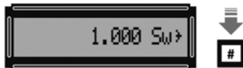
Fig.45 Una vez seleccionado el valor 1.000 Sw, para que comience la ejecución de la función de barrido (Sweep) hay que pulsar la tecla de confirmación #. En el display se mostrará el signo >.
