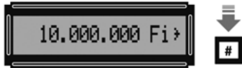
Fig.41 Para cambiar la frecuencia inicial hay que pulsar 3 veces en la tecla MODE, así aparecerá la indicación 0 Fi. Ahora ya solo hay que escribir el nuevo valor, por ejemplo 10.000.000.
