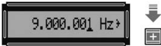
Fig.25 Pulsando la tecla + la frecuencia aumenta 1 Hertzio. Cuando se utilizan las teclas +/- para cambiar la frecuencia no es necesario utilizar la tecla de confirmación (#).
