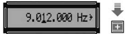
Fig.29 Una vez que se llega a 9.009.000 Hz si se mantiene presionada la tecla + la frecuencia sigue subiendo. Si se presiona la tecla - la frecuencia disminuye.
