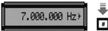
Fig.50 Ahora hay que introducir la frecuencia que se desea obtener y, a continuación, presionar la tecla # de confirmación.
