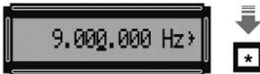
Fig.27 Para variar la frecuencia de 9.000.000 Hz > en saltos de 1.000 Hz mediante las teclas +/- hay que presionar la tecla * hasta que quede activada (subrayada) la cuarta cifra empezando por la derecha.
