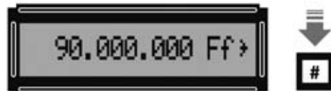
Fig.42 Pulsando la tecla # en el display aparece la indicación 0 Ff. Ahora solo hay que escribir el nuevo valor, por ejemplo 90.000.000 y, a continuación, la tecla # de confirmación.
