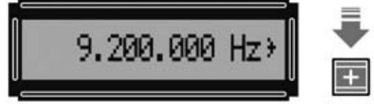
Fig.32 Presionando la tecla + la frecuencia siempre aumenta con saltos de 100.000 Hz (100 KHz). Accionando la tecla - la frecuencia disminuye en saltos de 100 KHz.
