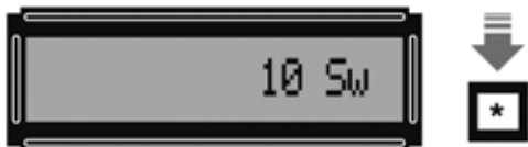
Fig.39 Utilizando la tecla * se puede elegir la velocidad de barrido: 1-10-100-1.000 ...
