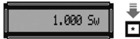
Fig.44 Utilizando la tecla * se puede elegir la velocidad de barrido. En este caso hemos elegido 1.000 Sw (incrementos de 1.000 Hz).
