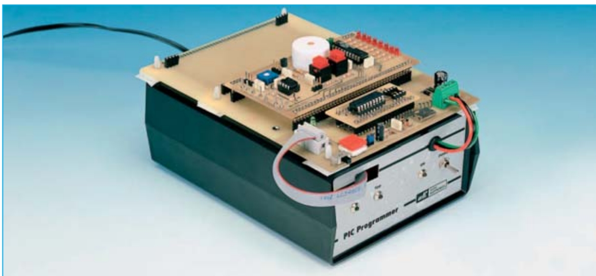
Fig.29 Fotografía del Programador para PIC LX.1580, incluyendo el Bus LX.1581 y la tarjeta Experimental LX.1582. Todos estos proyectos han sido publicados en la revista Nº238.
