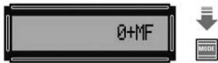
Fig.55 Presionando una sola vez la tecla MODE en el display aparece la indicación 0+MF.
