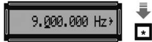
Fig.30 Para variar la frecuencia en saltos de 100.000 Hz con las teclas +/- hay que presionar la tecla * hasta que quede activada (subrayada) la sexta cifra empezando por la derecha. A continuación hay que utilizar las teclas +/-.
