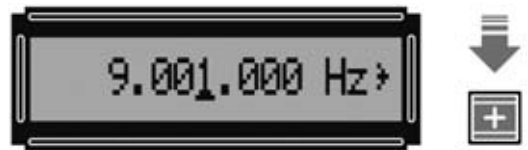
Fig.28 Presionando la tecla + la frecuencia aumenta 1.000 Hz cada vez. Incluso aunque se llegue a 9.009.000 Hz la frecuencia continuará subiendo en saltos de 1.000 Hz.
