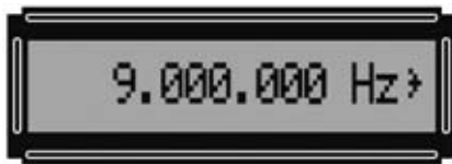
Fig.23 Una vez introducido un valor de frecuencia se puede variar en unos pocos Hz-KHz-MHz utilizando las teclas +/-.
