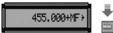
Fig.51 Si no se recuerda el valor de la MF memorizada hay que pulsar la tecla MODE.
