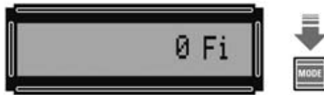
Fig.34 Una vez que en el display aparece el valor inicial 0 Hz hay que pulsar 2 veces la tecla MODE. En el display aparece la indicación Fi (Frecuencia inicial).
