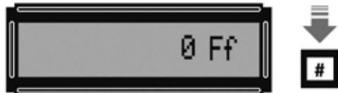
Fig.36 Volviendo a pulsar la tecla # en el display aparece la indicación Ff (Frecuencia final).
