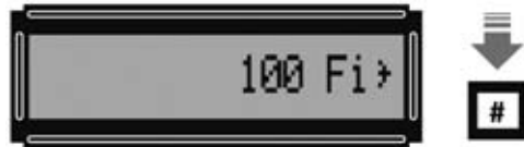
Fig.35 Hay que introducir un valor, por ejemplo 100. A continuación hay que confirmar con la tecla #. En el display aparecerá la indicación 100 Fi > (Frecuencia inicial 100 Hz).
