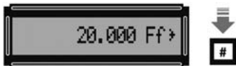
Fig.37 Hay que introducir un valor, por ejemplo 20.000. A continuación hay que confirmar con la tecla #. En el display aparecerá la indicación 20.000 Ff > (Frecuencia final 20.000 Hz).
