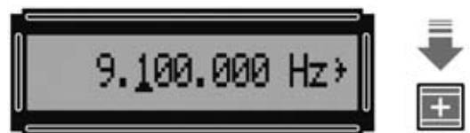
Fig.31 Presionando la tecla + la frecuencia aumenta 100.000 Hz cada vez.
