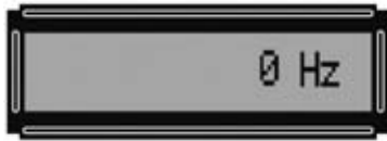
Fig.46 Para sumar un valor de MF hay que comenzar desde el punto inicial, encendiendo el Generador y esperar al valor 0 Hz.
