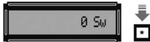
Fig.43 Para seleccionar la velocidad en el barrido hay que utilizar la tecla *. En el display aparece la indicación 0 Sw (Sweep).
