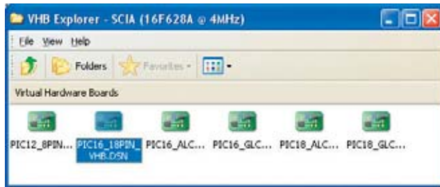
Fig.26 Haciendo click en el icono LABCENTER ELECTRONICS (ver Fig.16) se abre el aplicativo utilizado para ejecutar el programa sobre tarjetas virtuales. Para trabajar con el PIC 16F628A hay que hacer click en la tarjeta PIC16_18PIN_VHB.DSN .
