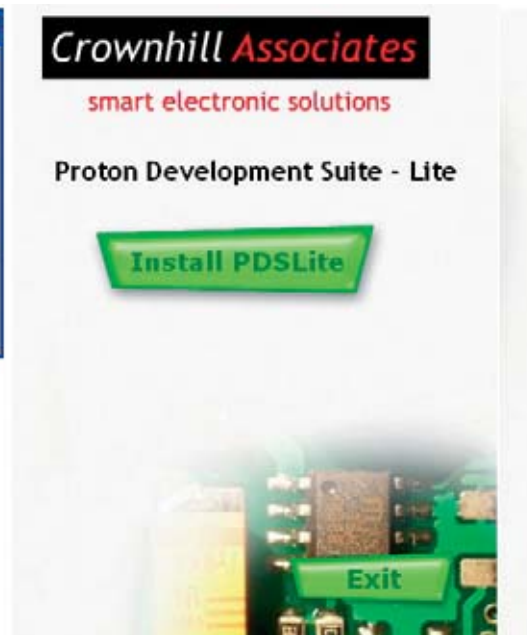
Fig.2 Para comenzar la instalacin hay que hacer click en el botn EJECUTAR de la ventana de descarga (ver imagen superior). En la ventana inicial del programa de Crownhill (ver imagen lateral) hay que hacer click en INSTALL PDSLITE. El resto del proceso de instalacin est guiado por un asistente (solo hay que confirmar las diferentes opciones haciendo click en NEXT >). Confirmada la ltima ventana (OK) termina la instalacin.
