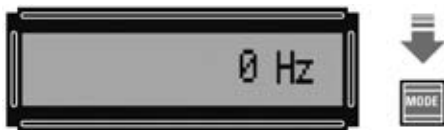
Fig.49 Pulsando 2 veces la tecla MODE en el display aparece la indicación 0 Hz.
