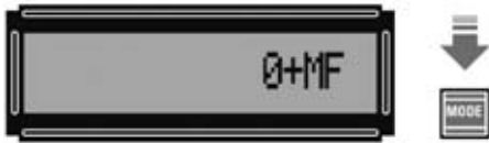
Fig.47 Presionando una sola vez la tecla MODE en el display aparece la indicación 0+MF.
