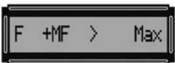
Fig.52 Este mensaje indica que se ha superado el valor de 120 MHz.
