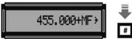
Fig.48 Ahora hay que escribir, en Hertzios, el valor de la MF que se desea sumar y presionar la tecla # de confirmación.
