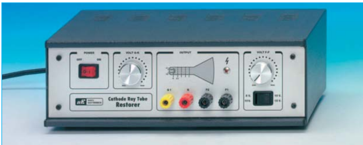
Fig.14 Fotografía del mueble metálico que aloja el Regenerador de tubos de rayos catódicos. En el artículo hemos explicado detalladamente la forma de utilizar este dispositivo. Quienes no tengan una adecuada preparación técnica han de recurrir a personal especializado.
