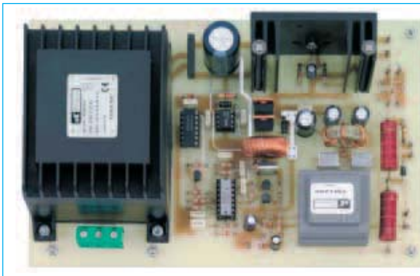
Fig.9 Fotografía del circuito impreso del Regenerador de tubos de rayos catódicos una vez completado su montaje. Se puede apreciar claramente la aleta de refrigeración en forma de U omitida en el esquema de la Fig.8. Al instalar los circuitos integrados en sus zócalos hay que orientar hacia arriba sus muescas de referencia en forma de U.
