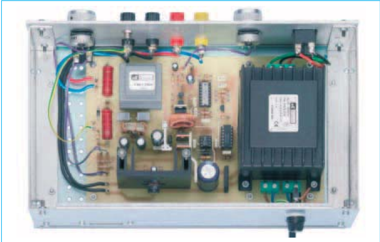
Fig.10 Fotografías, trasera y frontal, del circuito impreso instalado en su mueble contenedor. Se pueden observar con claridad las conexiones de los bornes de salida y de los potenciómetros que regulan la alta tensión entre Rejilla y Cátodo, y la tensión de alimentación de los filamentos.
