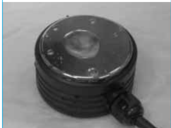
Fig.27 En cambio, en el Generador de ultrasonidos de 3 MHz el agua no se vaporiza sino que se concentra hacia el centro del difusor.
