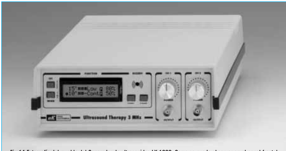
Fig.14 Fotografía del mueble del Generador de ultrasonidos LX.1660. Como se puede observar en el panel frontal se encuentran los dos conectores BNC para la conexión de los difusores y los potenciómetros de regulación de la potencia de los canales CH1 y CH2.
