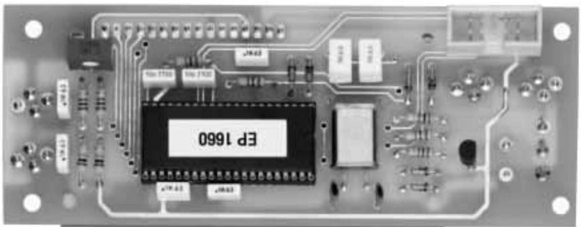
Fig.19 Fotografía del circuito impreso LX.1661, visto por el lado opuesto al display. En el centro se observa el microprocesador ST7 programado (EP1660) y, a su derecha, el cuarzo de 8 MHz montado en posición horizontal.
