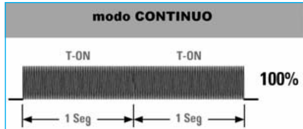
Fig.6 Cuando el Generador funciona en modo CONTINUO la señal de 3 MHz se aplica al difusor sin interrupciones durante todo el ciclo. En este modo de funcionamiento toda la potencia indicada en el display se lleva al difusor.
