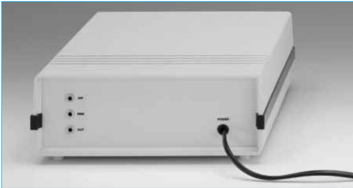
Fig.24 En esta fotografía se muestra el panel posterior del Generador con los conectores INP, REM y OUT utilizados para conectar generadores en cascada. Al conector REM se conecta el pulsador Remoto que permite interrumpir en cualquier momento la sesión.
