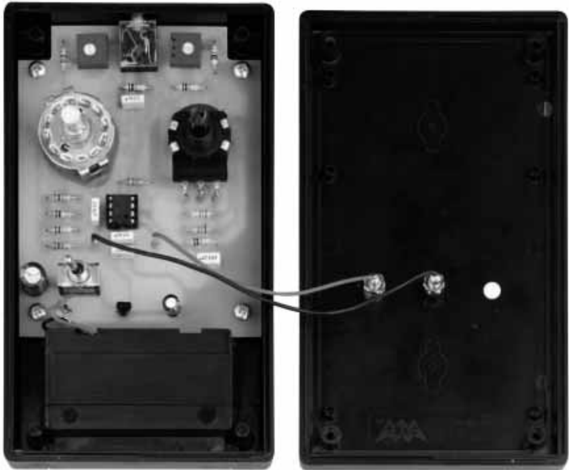
Fig.11 Fotografía del prototipo del circuito impreso instalado en el mueble. El cableado no presenta ninguna dificultad, únicamente hay que respetar las polaridades (+/rojo) (-/negro). En la tapa se fijan los dos bornes para conectar las puntas del téster. Al montar estos bornes hay que aislarlos con sus arandelas de plástico (ver Fig.10).
