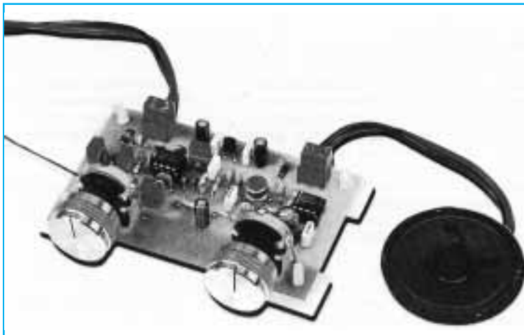
Aspecto final del circuito LX.1529 una vez montados todos sus componentes, incluyendo la conexión del altavoz, cables de alimentación y antena.
