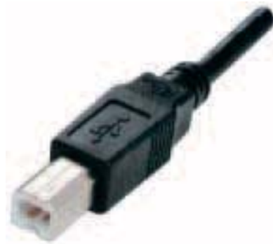
Fig.9 Conector macho USB tipo B. Este conector se suele incluir en impresoras, escáners y discos duros externos de 3,5". Para conectarlos al PC se precisa un cable denominado A-B ya que el conector del PC es tipo A y el conector de estos periféricos es tipo B.
