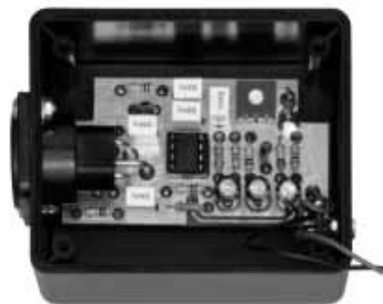
Fig.12 Aspecto del circuito impreso LX.1677 una vez instalado en su mueble contenedor.
