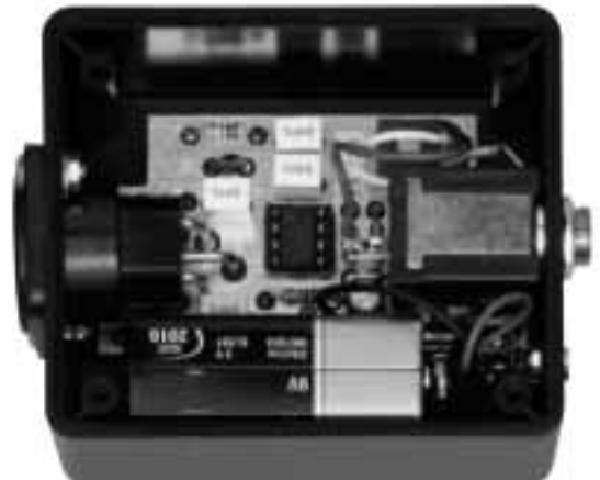
Fig.13 Antes de cerrar el mueble hay que instalar una pila en el portapilas y alojarla en el espacio reservado para ella.
