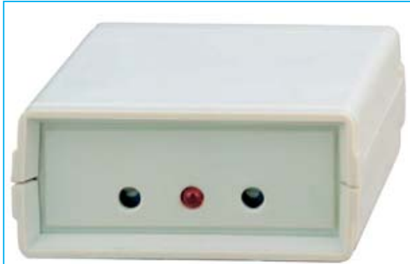
Fig.1 Fotografía del antirrobo por radar a 10 GHz con tecnología DRO. Como se puede apreciar no ha sido necesario abrir una ventana en la tapa del mueble ya que el haz de microondas de 10 GHz lo atraviesa sin sufrir ninguna atenuación.
