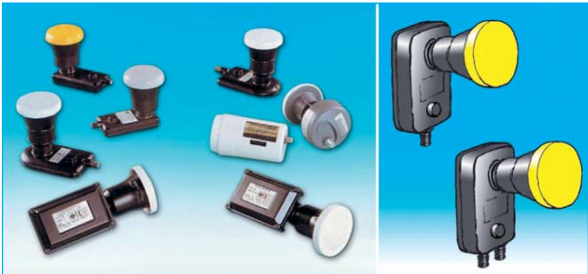
Fig.10 En el mástil de las antenas parabólicas siempre hay un convertidor LNB cuya función es amplificar las frecuencias de 10,75 a 12,7 GHz y convertirlas en frecuencias de 950 a 1.750 MHz. Para poder recibir todas las emisoras con polarización Vertical y Horizontal es necesario modificar la tensión de alimentación del LNB, operación que realiza el Decodificador.
